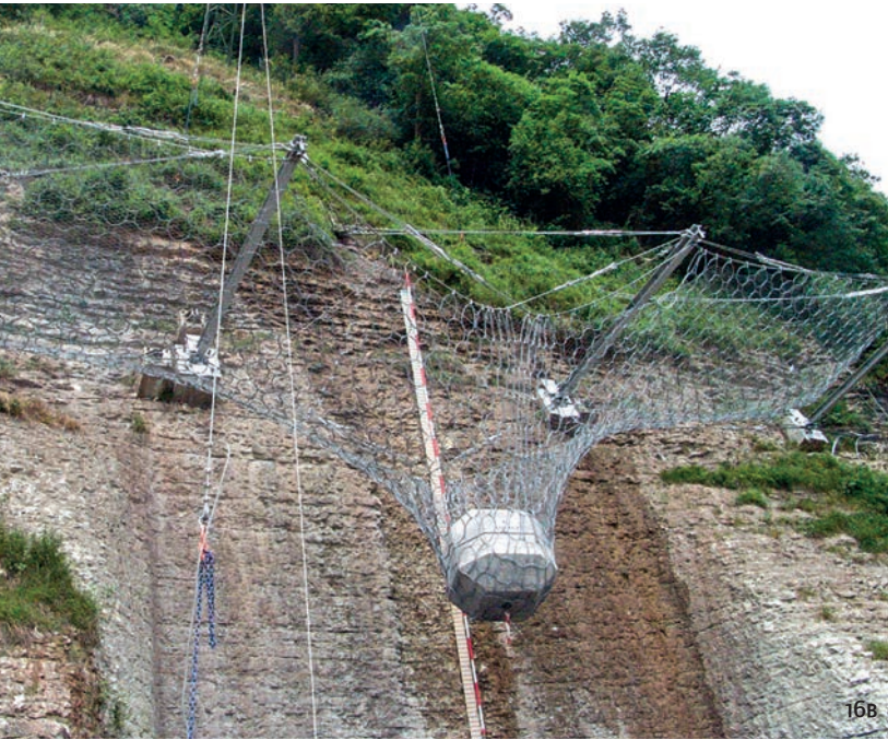
16A|16B Prove per i sistemi paramassi a) punching test b) prova di lancio
