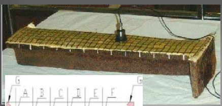
Difetti simulati con diametro di mm 10 (A), 15 (B), 20 (C-F)
