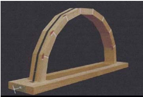
Immagine del modello in legno utilizzato per l'analisi dei cinematismi in presenza e in assenza di configurazione di rinforzo estradosale non aderente.
