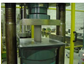
Calcestruzzo: prova di compressione diretta
