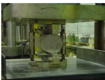
Calcestruzzo: prova di compressione indiretta "brasiliana"
