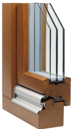
Finestra in legno a due ante e vetrocamera con vetri stratificati con pellicola PVB acustica
