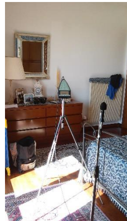
Rilievi fonometrici nell'ambiente interno
